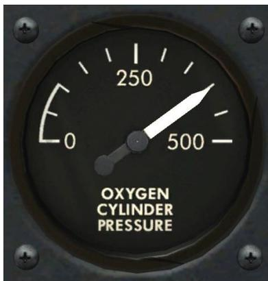
**Рисунок 55: Указатель давления кислородной системы**
