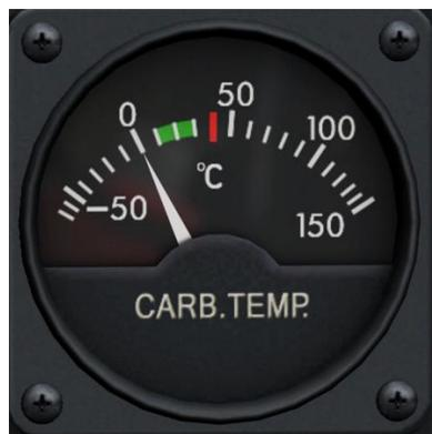
**Рисунок 49: Указатель температуры воздуха в карбюраторе**
