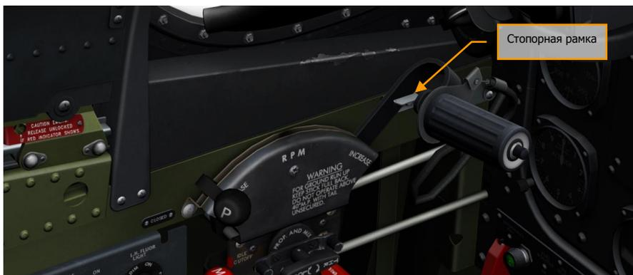
Рисунок 18: Чрезвычайный режим (War Emergency Power, WEP)
