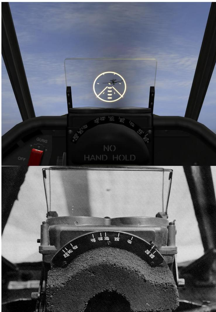
Рисунок 112: Пример оформления шкалы размера крыльев прицела К-14
