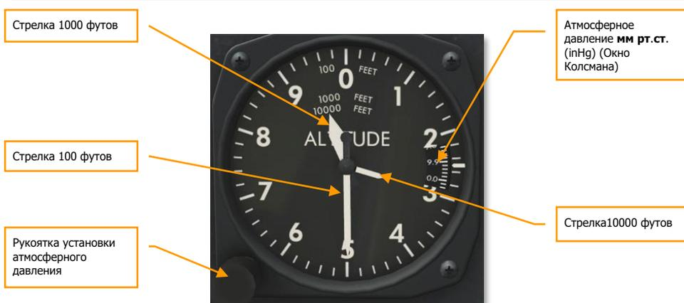
**Рисунок 45: Барометрический Высотомер AN5760-2, показания соответствуют 29500 футам.**
