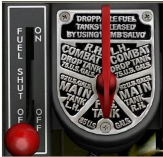
**Рисунок 19: Селектор топливных баков**
