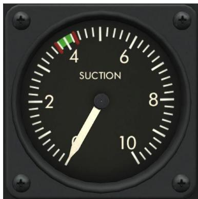
Рисунок 43: Вакуумметр
