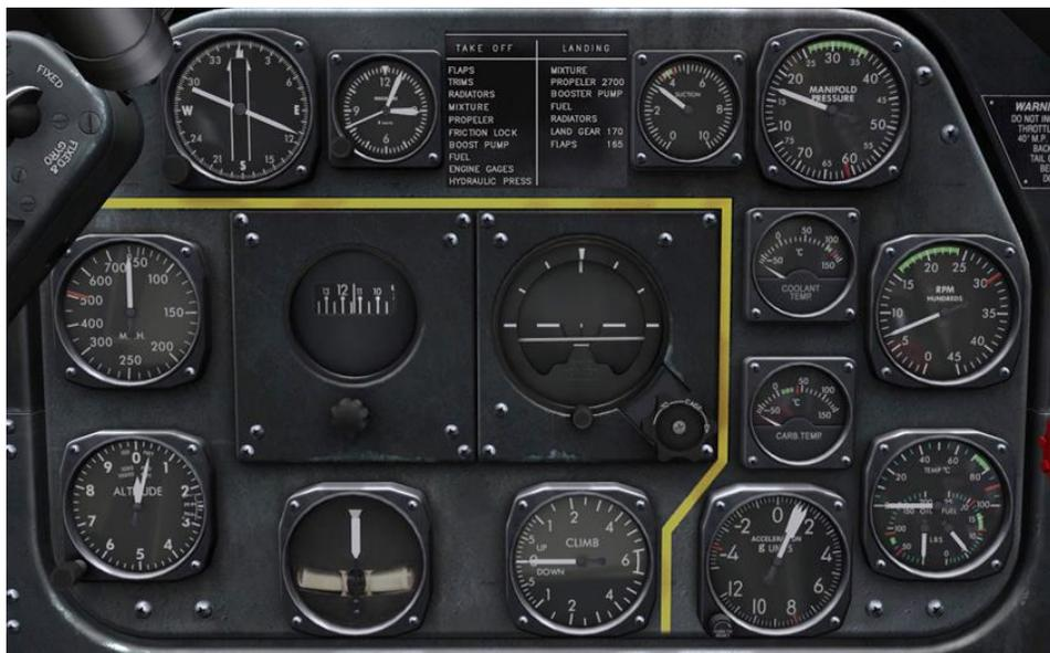
**Рисунок 39: Панель приборов самолета P-51D**
