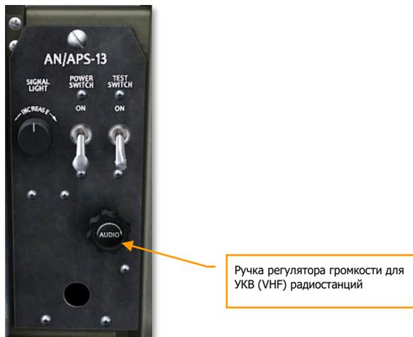
**Рисунок 75: Панель управления РЛС защиты хвоста AN/APS-13**
