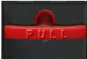
**Рисунок 63: Рукоятка Аварийного Открытия Створок Шасси**
