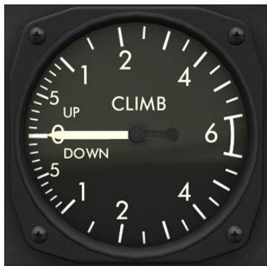
**Рисунок 46: Указатель Вертикальной Скорости (Вариометр)**
