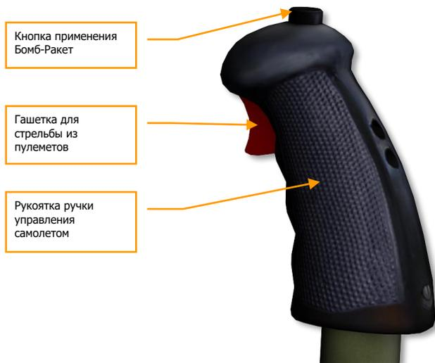
**Рисунок 31: Ружка Управления Самолетом (РУС)**
