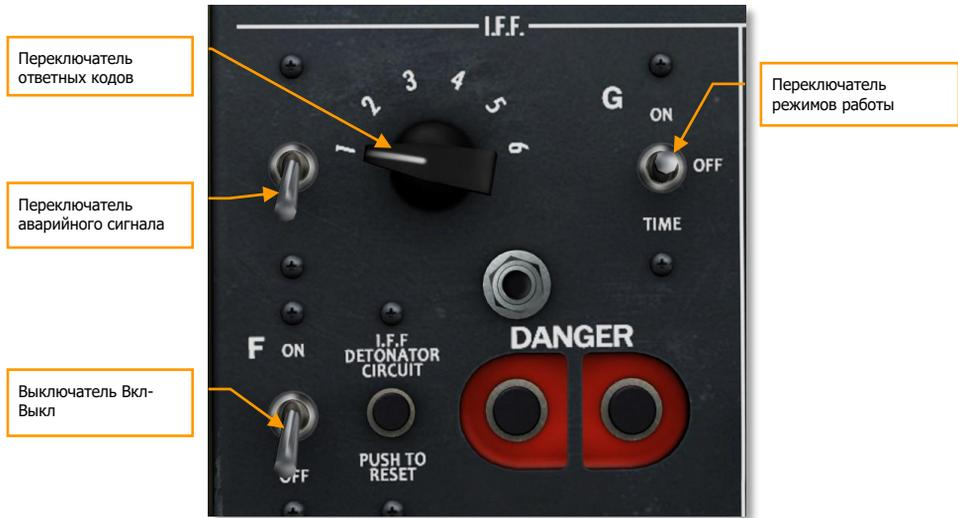
Рисунок 77: Панель управления СРО SCR-695-А
