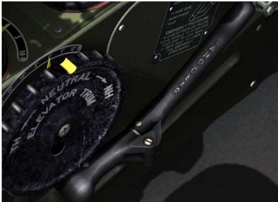
Рисунок 70: Рычаг крана шасси
