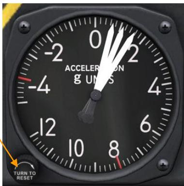
Рисунок 58: Указатель перегрузки
