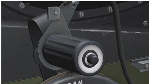
**Рисунок 95: Рычаг управления двигателем с поворотной рукояткой**
