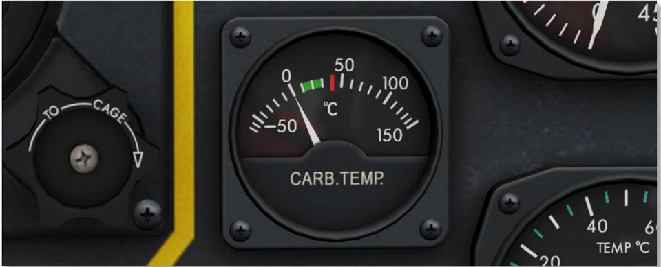
**Рисунок 88: Рекомендуемый диапазон температуры воздуха, поступающего в карбюратор, составляет 15...30°C (59...86°F), максимум 40°C (104°F)**
