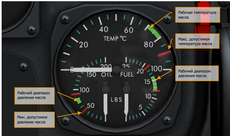
**Рисунок 84: Макс. допустимая температура масла 90°C (194°F), рабочая температура масла 70 ... 80°C (158 ... 176°F).**
