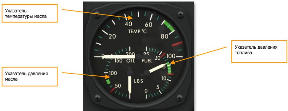
**Рисунок 51: Комбинированный трехстрелочный Указатель Давления Топлива, Давления и Температуры Масла Двигателя**
