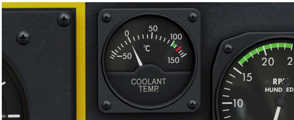
Рисунок 87: Макс. температура охлаждающей жидкости составляет 121°C (250°F), рабочий диапазон 100...110°C (212...230°F)
