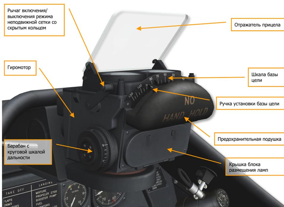
**Рисунок 36: Прицел К-14 с вычислителем упреждения**
