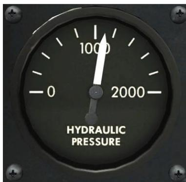
**Рисунок 56: Указатель давления в гидросистеме**
