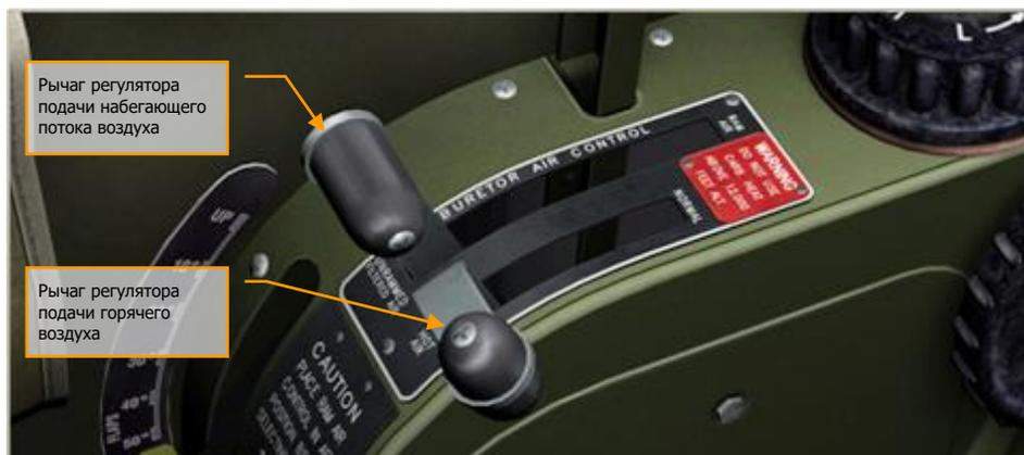
Рисунок 67: Регуляторы подачи воздуха в карбюратор
