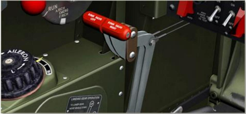
Рисунок 69: Ручки аварийного сброса бомб
