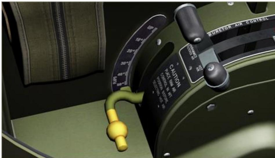
Рисунок 68: Рычаг Управления Закрылками
