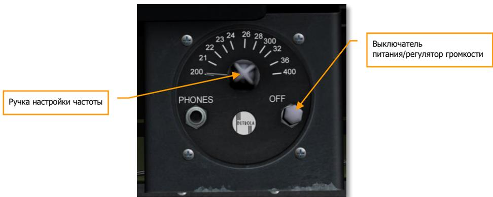
**Рисунок 79: Низкочастотный Радиоприемник BC-1206 "Detrola"**
