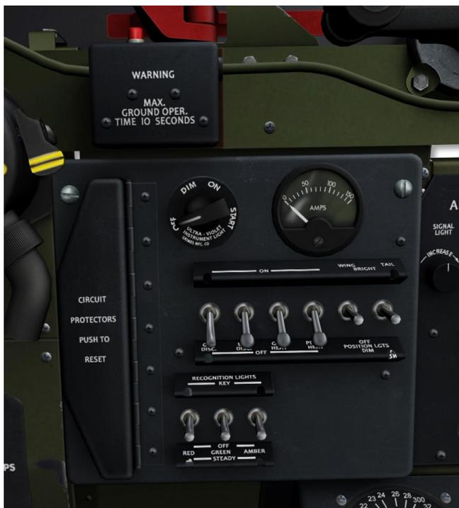
**Рисунок 26: Панель управления электрической системой**
