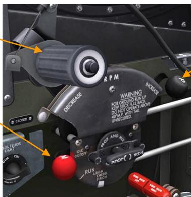
Рычаг регулятора оборотов воздушного винта установить в положение INCREASE.
