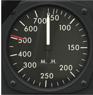
Рисунок 44: Указатель воздушной скорости
