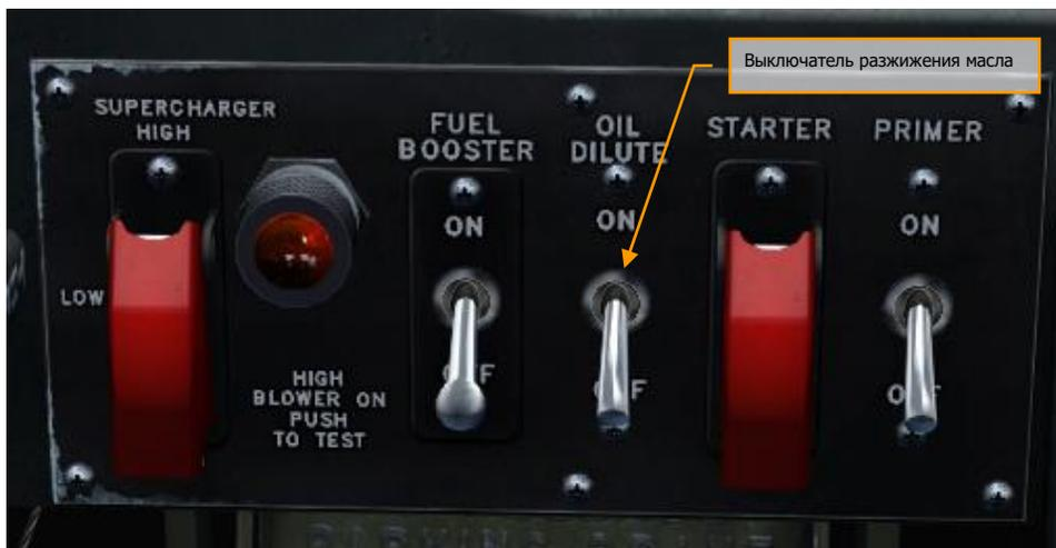
**Рисунок 24: Выключатель разжижения масла**
