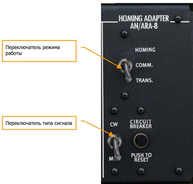
**Рисунок 78: Приводное Устройство AN/ARA-8**
